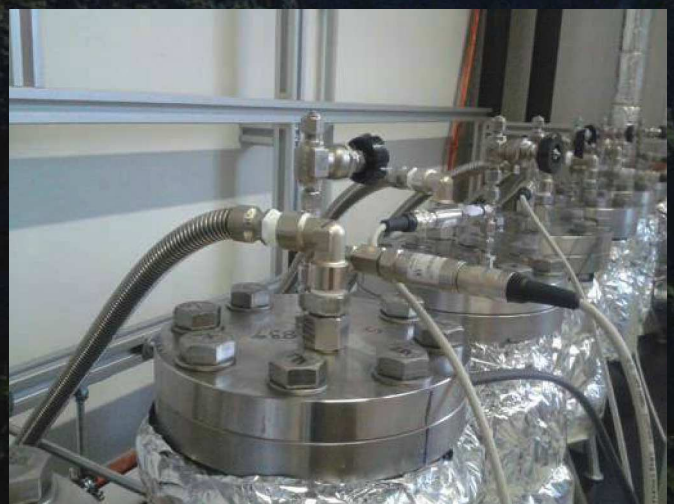
Versuchsaufbau der Hochdruck-Bioreaktoren zur Simulation eines Erdgasspeichers mit Monitoring-Equipment zur Gasprobenentnahme sowie Druckmessung – Detailaufnahme
