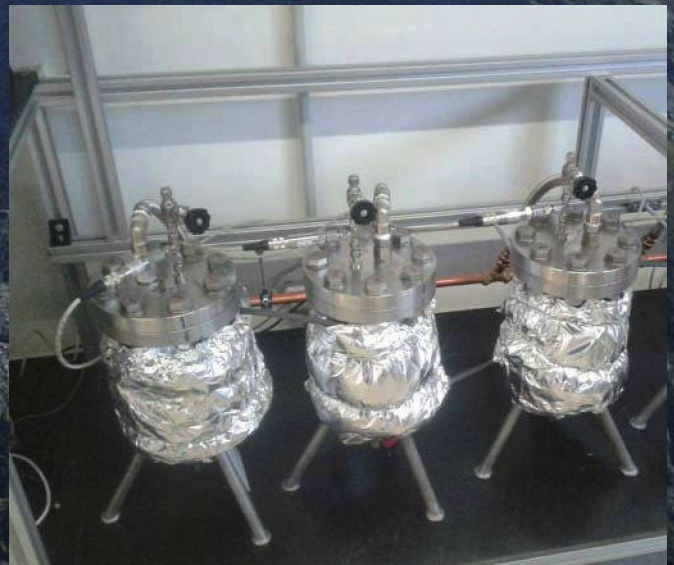
Versuchsaufbau der Hochdruck-Bioreaktoren zur Simulation eines Erdgasspeichers mit Lagerstättenwasser und unterschiedlichen Methan/Wasserstoff-Gehalten
